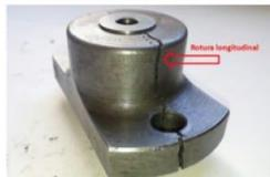
Figura 1: carcaça fraturada, utilizada em forjamento a frio (cortesia Nutép, 2019)
